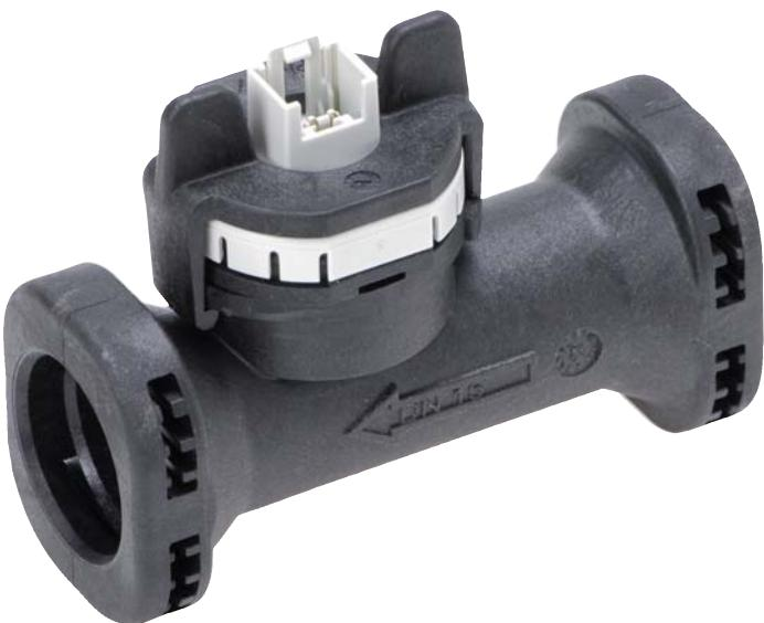
Датчик расхода типа 200 основан на принципе измерения вихревой дорожки Кармана. Заказчику предоставляется возможность выбора из нескольких версий устройства. Датчик типа 200 поставляется как с модулем измерения температуры, так и без него. Не имея подвижных частей, датчик расхода не чувствителен к загрязнениям, обеспечивает минимальные потери давления и высокую точность.
