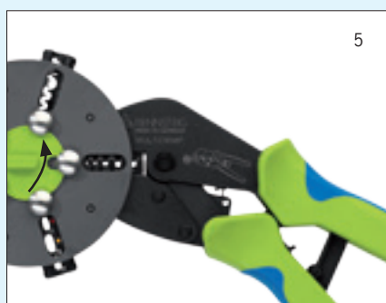
1–6: Быстрая смена плашек без вспомогательного инструмента – просто защелкнуть и готово! 1–6: Fast, tool-free die change - one click and you're done
