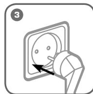
**3** Подключите сетевой кабель в розетку 230 В/50 Гц. Помпа готова к работе
