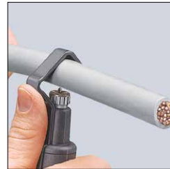
Umfangsschnitt Circular cut
