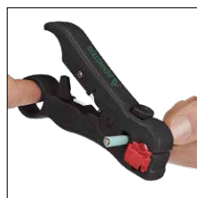
Abisolieren von Rundkabel Stripping of round cables
