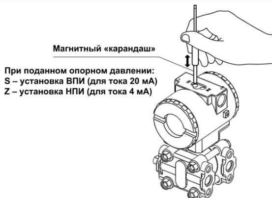
Рисунок 6.2 – Расположение местных регуляторов настройки, отверстие установки нуля обозначено Z (Zero), диапазона – S (Span)
