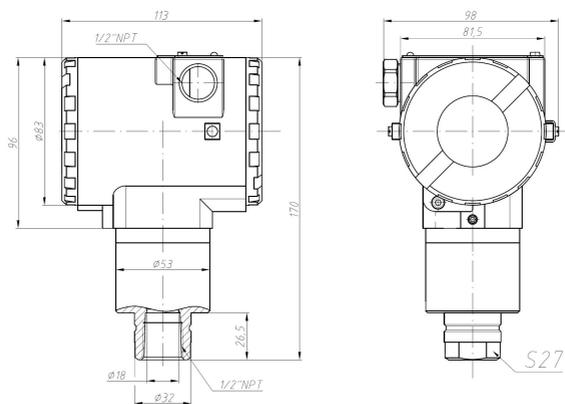
Рисунок Б.4 – Габаритные размеры датчика AMZ 5450
