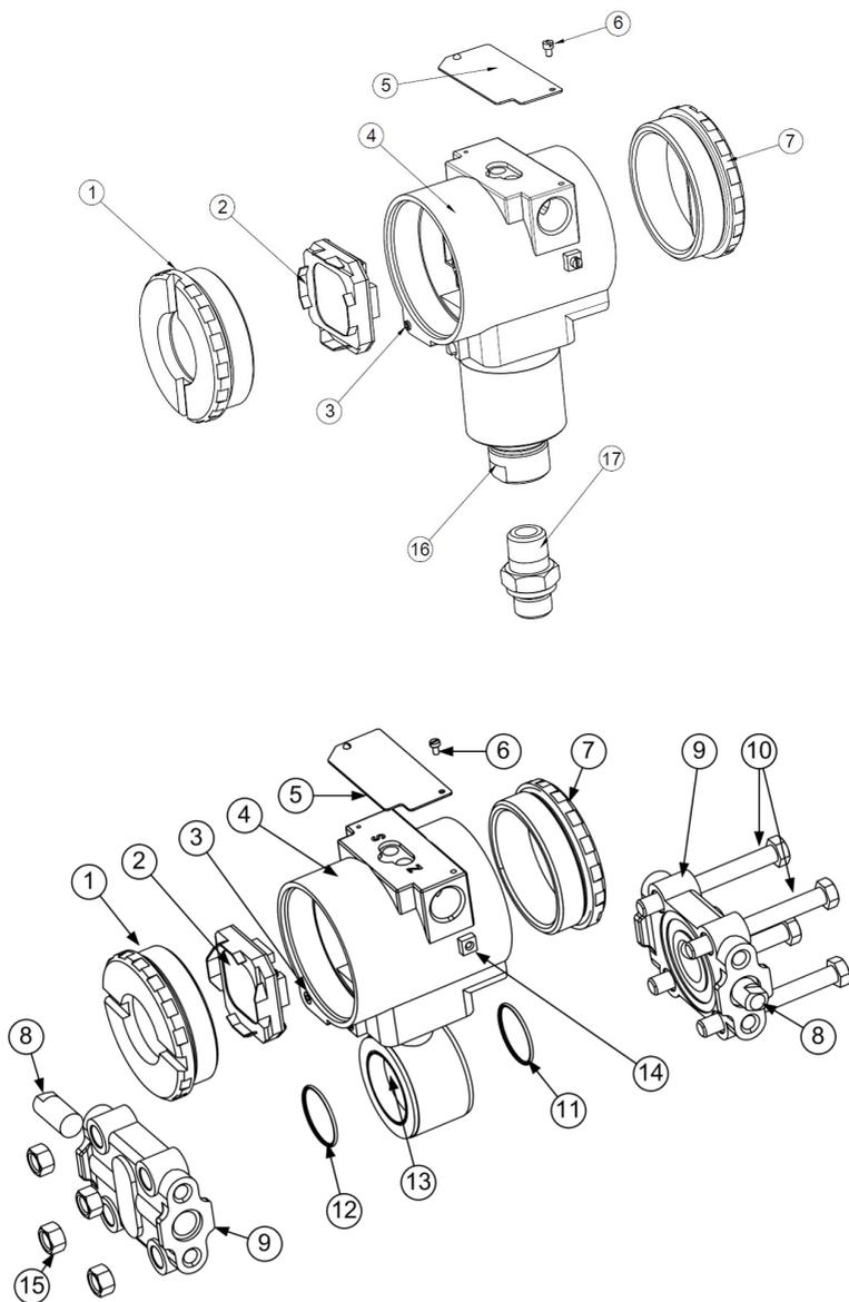
Рисунок 3.2 – Основные составные части датчиков AMZ 5050, AMZ 5450
