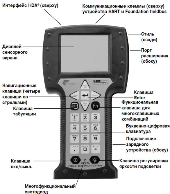
Рисунок Д.1 – Назначение элементов управления коммуникатора модели 375
