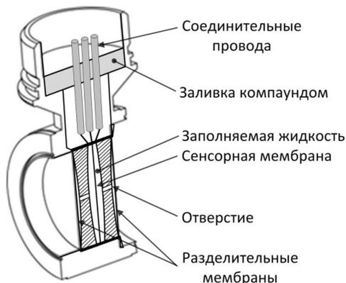
Рисунок 3.3 – Конструкция емкостного сенсора
