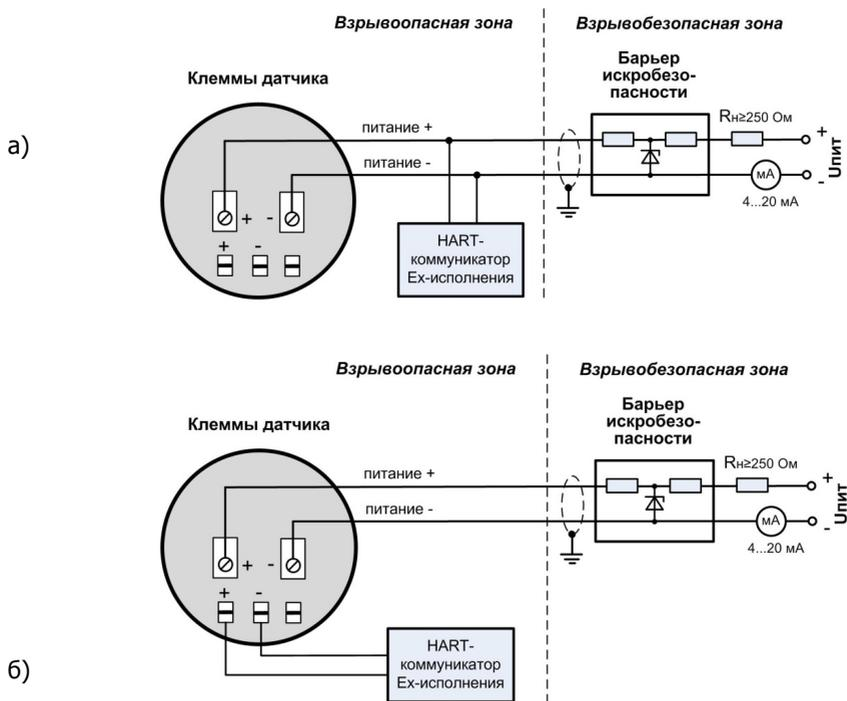
Рисунок Ж.2 – Подключение HART-коммуникатора к приборам AMZ 5050/5450:
