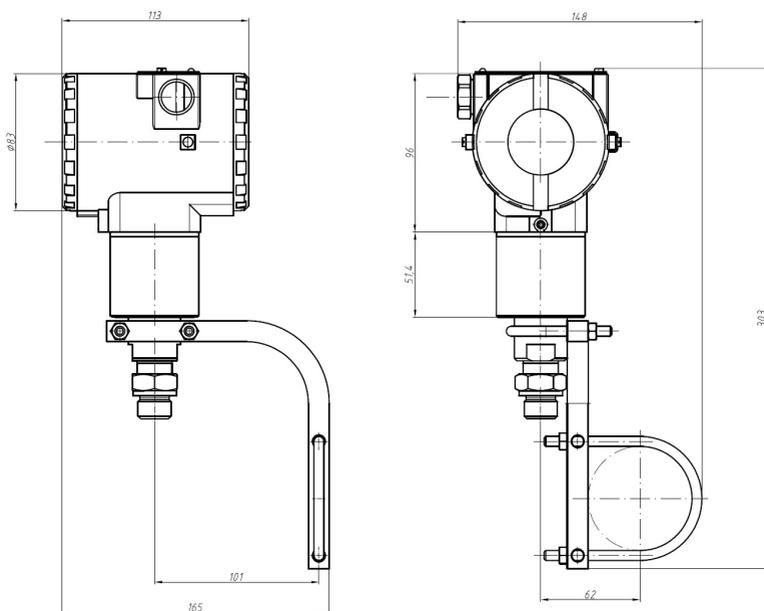
Рисунок Б.5 – Крепление AMZ 5450 к трубе 2" на угловом кронштейне
