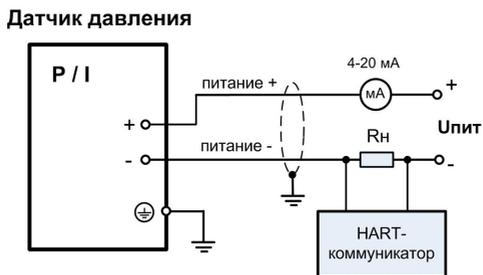
Рисунок В.5 – Подключение HART-коммуникатора к приборам AMZ 5050/5450
