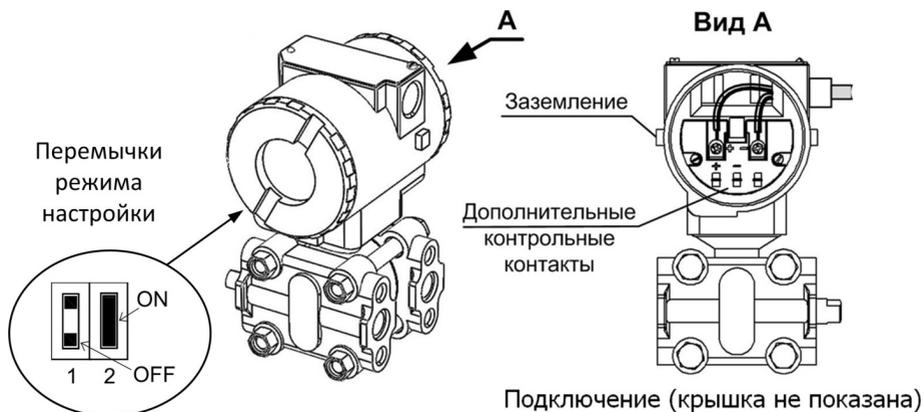
Рисунок В.1 – Расположение контактов на клеммной колодке и переключателей режима настройки под крышками
