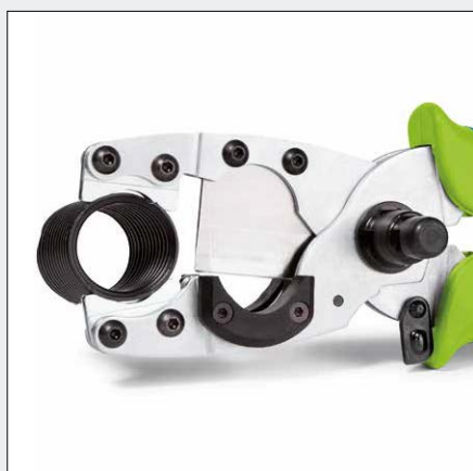
Schneiden des Schutzrohres Cutting protective outer pipe
