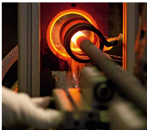
Induktives Härten der Meißel Inductive tempering
